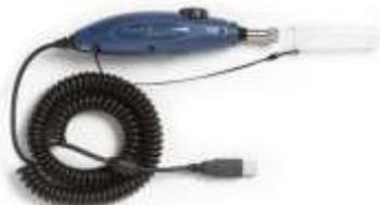
Видеомикроскоп USB Fluke Networks FI-1000 для инспектирования оптоволоконна. Обследования коннекторов с комплектом адаптеров (LC,FC/SC, 1,25 и универсальные 2,5 мм адаптеры). Подключается к любым устройствам серии Versiv: CertiFiber Pro, OptiFiber Pro и DSX CableAnalyzer).
