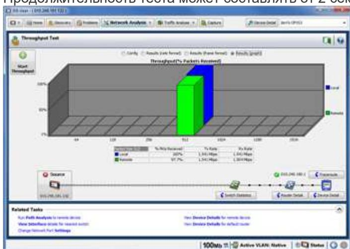
Результаты тестирования могут быть представлены в режиме вкладок или графическом виде. В режиме вкладок в формате Rate отображается скорость передачи и получения данных на локальном и удаленном устройстве, а также общее количество кадров, полученных этими устройствами. При переключении в режим вкладок в формате Frame Format показывается количество переданных и полученных кадров на локальном и удаленном устройстве, а также общее количество кадров, полученных этими устройствами.
