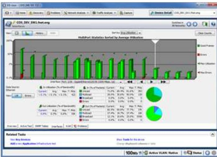
WAN-соединениями. Анализатор отображает информацию о настройках WAN-соединения, предоставляет в графическом виде информацию о загрузке и уровне ошибок, а также идентифицирует специализированные ошибки для соединений ISDN, Frame Relay, T1/E1, T3 и ATM.
